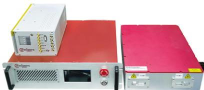
该产品分别采用 1050nm 和 1550nm 窄线宽激光作为种子光源,经过单频光纤放大和周期性极化晶体和频过程产生窄线宽、大功率的 626nm 激光,然后级联一个高效的外腔谐振倍频器将频率转换到 313nm 紫外波段。相比于半导体 + 锥形放大器级联两个谐振倍频腔的技术方案,该产品具有结构更紧凑稳定,激光输出功率更大,相对强度噪声 (RIN) 更小等特点。
